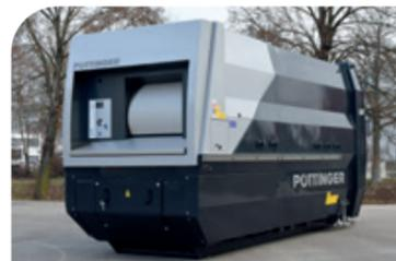
Der Absetzer ist ausschließlich mit Fronteinwurf und optional mit Vordach erhältlich.
