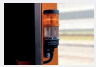
Les lampes de signalisation permettent aux chargeurs de contrôler le cycle de pesage
