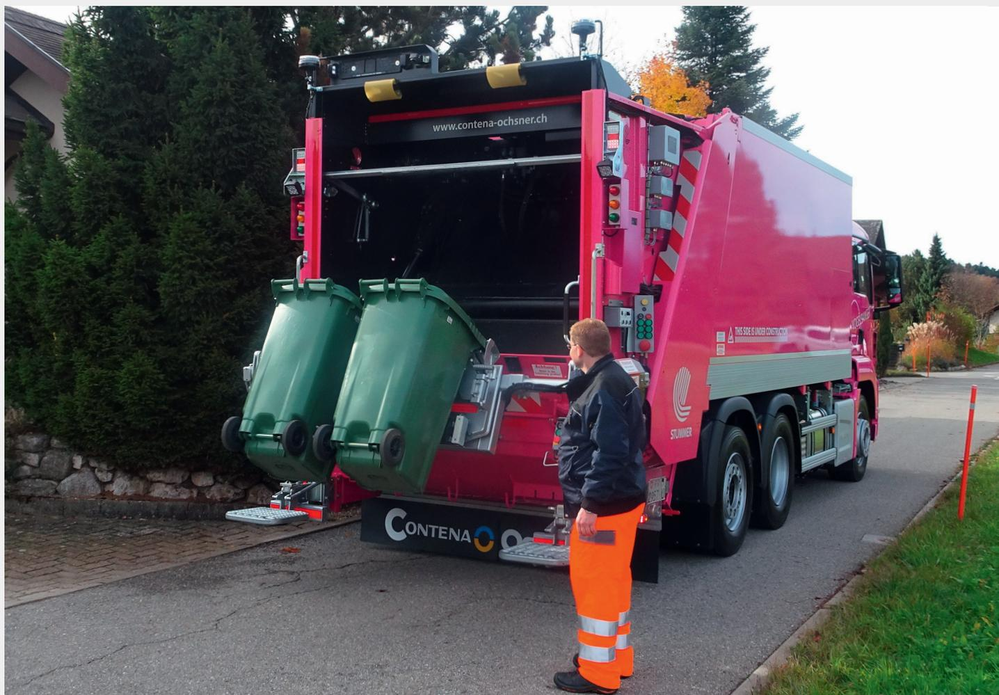
Le véhicule est équipé d'un double lève-containers. Chaque partie du lève-containers est équipée de pesons placés entre les bras et le mécanisme de levage. Le double lève-containers mesure une première fois le poids des containers durant la phase de levée et une deuxième fois pendant la phase de descente et ceci sans s'arrêter. La différence entre les deux poids donne la valeur de pesage. Les données sont enregistrées pour chaque client.
