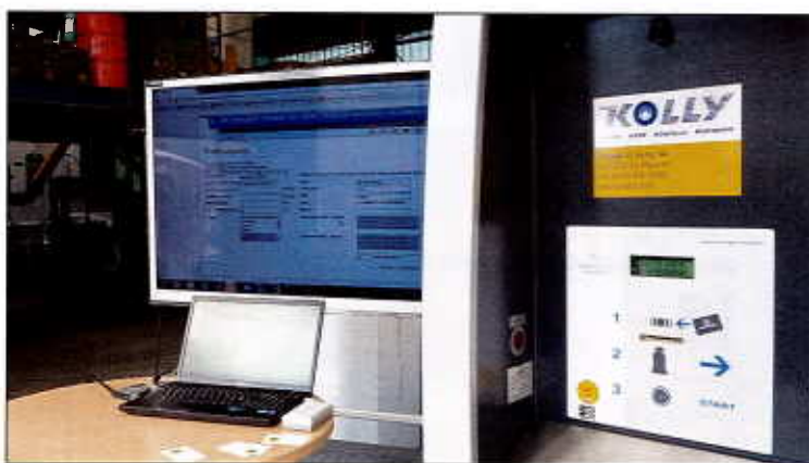
De la citerne à l'ordinateur: Dominique Kolly (en haut) montre un système de pesage dont les données peuvent être gérées en temps réel sur Internet.
